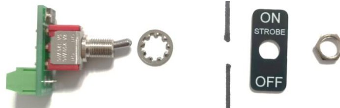
Interrupteur + rondelle côté interne // plaquette et écrou côté pilote
